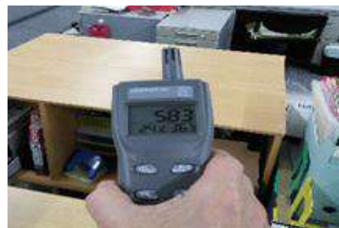
<室内環境の測定（CO 2 計）>
