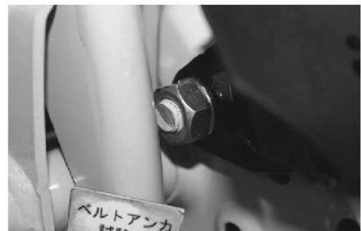
試験後 ベルトアンカ 窓席左側
