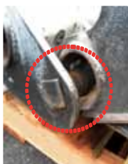
プレート連結ボス部 の異常摩耗
