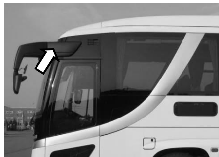
バックミラーカバー内までケーブル施工 車外カメラは車幅を超えて取付けないこと
