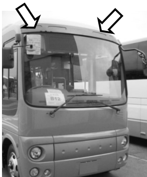
天井部ガーニッシュ内までケーブル施工
