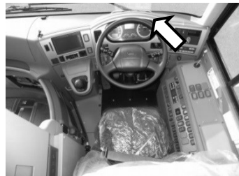
天井前方部またはインストルメントパネル部までケーブル施工
