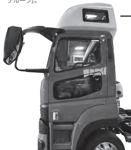
大型トラックのキャブのルーフに取り付けて、快適なスペースを作る「スーパーマルチルーフ」。
