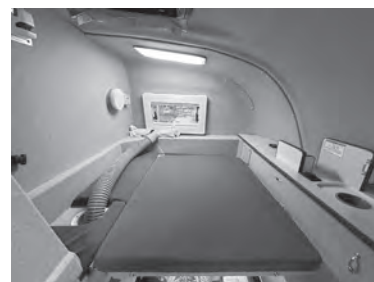
大型トラックのキャブのルーフに取り付けて、快適なスペースを作る「スーパーマルチルーフ」。
