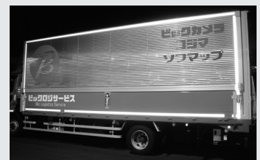
マーキングフィルムと再帰反射材による施工をした配送車両
