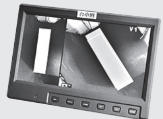
最新のオールビューモニターAVM348は4つのカメラの映像を合成し、真上から見た映像を作り出す。改正保安基準に適合し、車幅2.5mの車両に、単車・セミトレーラ・フルトレーラ・タンクローリー等、タイプを問わずに装着可能
