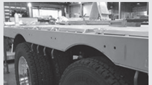
角パイプへの複雑な切欠きや穴空け加工が1工程で可能
