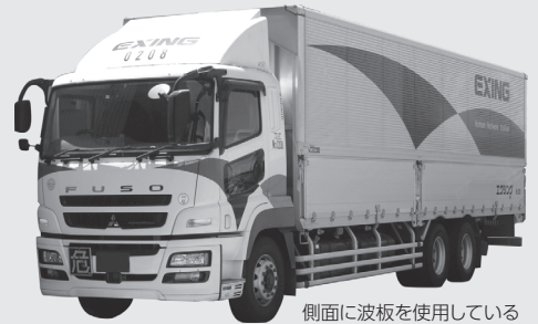
側面に波板を使用している
