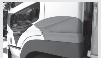
凹凸に合わせて作られ、イメージ通りに貼られると美しい仕上がりになる
