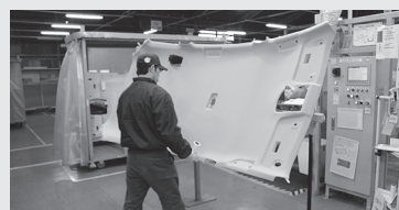
検品には人間の目視が必要。 ロボットはこの右側で作業している
