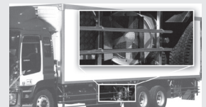
車体下部に発電機を取り付ける
