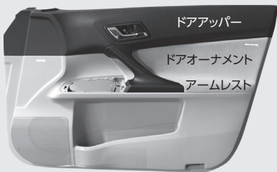
人が触れる様々な箇所に、用途に適した表皮材が使用されている。
