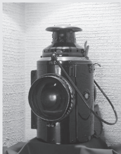
1915年創業当時で作られていた鉄道信号灯用フレネルレンズ。
