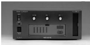
オール音声合成を実現した ラムコーダー「TLS-1」
