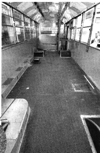
古くなったバスの床に張るだけで、高い防滑機能をもった床に変わります。
