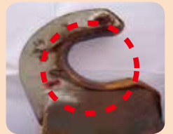
吊上フック摩耗・変形
