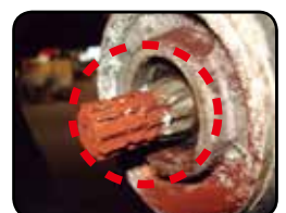
凍結防止剤侵入による錆び
