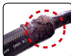
油圧ホースかしめ部腐食
