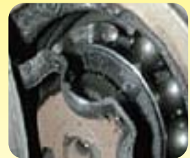
ベアリング破損
